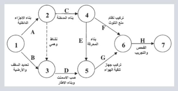
2-رسم شبكة محرقة الورق باستخدام طريقة النشاط على القطب AOA والحل موجود في الشكل 6-4. شكل 6-4
